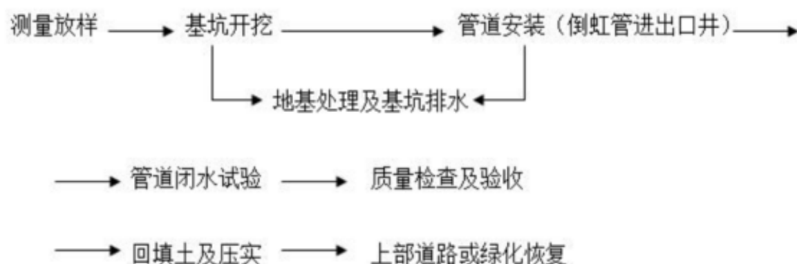
图5.9-1管道施工工艺流程
