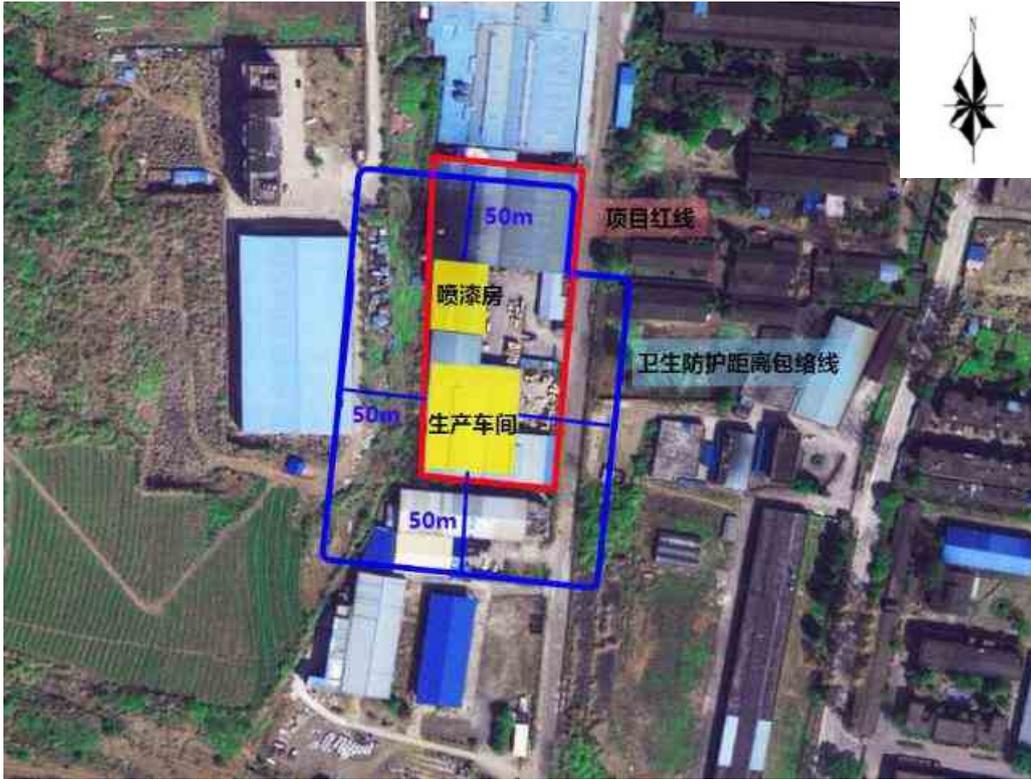
图 6.2-1 卫生防护距离包络线图
